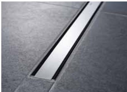
Das Modell Geberit „CleanLine60“ schließt bündig mit der Bodenfläche ab. Die Duschrinnen aus gebürstetem Edelstahl werden in drei Designvarianten angeboten und sind in den Längen von 30 bis 90 cm oder von 0,3 bis 1,3 m verfügbar. Eine werkseitig vormontierte Dichtfolie sorgt für eine fehlerfreie und sichere Abdichtung der Duschrinne. Bild: Geberit
