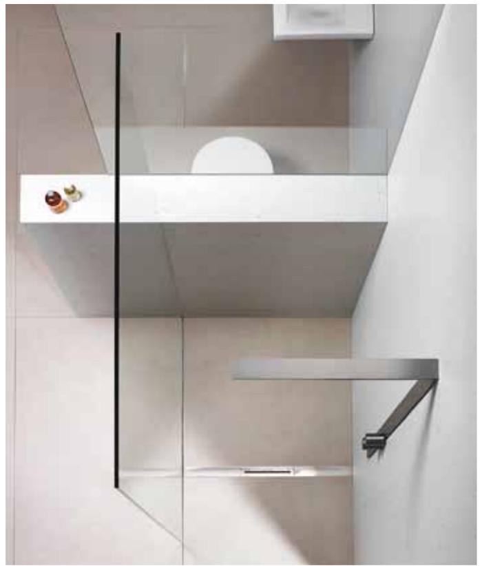
Die Ablaufschiene der Duschrinne „CeraFloor“ von Dallmer liegt als wasserführendes Element komplett oberhalb der Abdichtungsebene. Die Dichtmanschette wird per Klick-Mechanik sicher mit dem eingebauten Ablaufgehäuse verbunden und falten- sowie überlappungsfrei in die Verbundabdichtung eingebunden. Der tiefer platzierte Ablaufkörper ist durch eine umlaufende Estrichverankerung sicher im Boden fixiert. Bild: Dallmer
