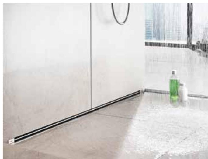
Mit dem „Advantix Vario-Wandablauf“ von Viega fließt das Wasser über die komplette Breite der Dusche ab. Mit nur 25 mm Einbautiefe kann der neue Ablauf auch vor eine bestehende Massivwand gesetzt werden; zugleich werden die Schallschutzvorgaben nach DIN 4109 und VDI 4100 eingehalten. Die serienmäßige Baulänge von 1200 mm kann stufenlos auf bis zu 300 mm Länge gekürzt werden. Bild: Viega
