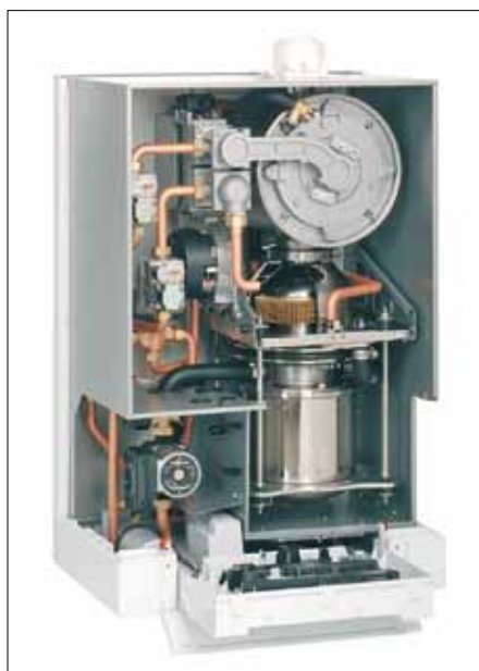
Viessmann Stirling: Viele Nano-BHKWs nutzen einen kompakten und geräuscharmen Stirlingmotor. Kaum größer als ein Brennwertkessel, ist damit sogar eine Wandmontage möglich.
