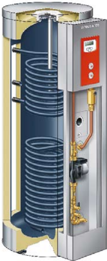
Bild 4: Bivalenter Speicher-Wassererwärmer mit vormontierten Solarkomponenten (Pumpengruppe, Verrohrung, Befüllarmatur, Solarregelung, zwei Speicherthermometer und Luftabscheider).
