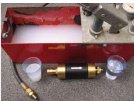
Bild 5: Prüfgerät und Hygienefilter.
