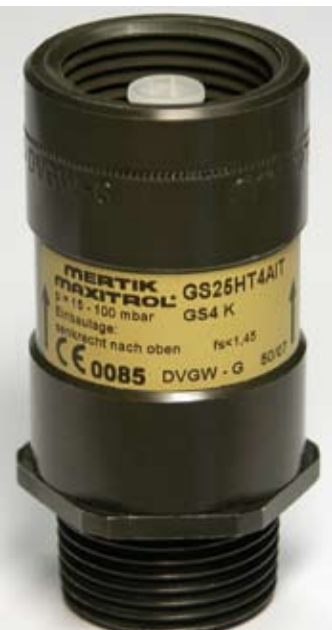
Bild 4: Bei der Installation von Kunststoff-Innenleitungen fordert die DVGW-TRGI 2008 grundsätzlich den Einbau eines leistungsangepassten Gasströmungswächters, der unmittelbar wärmeleitend mit einer zusätzlichen thermisch auslösenden Absperrvorrichtung verbunden sein muss.
