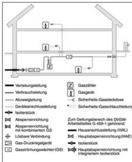
Bild 1: Mit der Überarbeitung der TRGI wurden neben Symboländerungen zur schematischen Darstellung auch neue Symbole aufgenommen, wie der Gasströmungswächter und die Gassteckdose.
