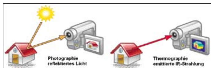
■ Bild 2: Fotografie und Thermografie.
