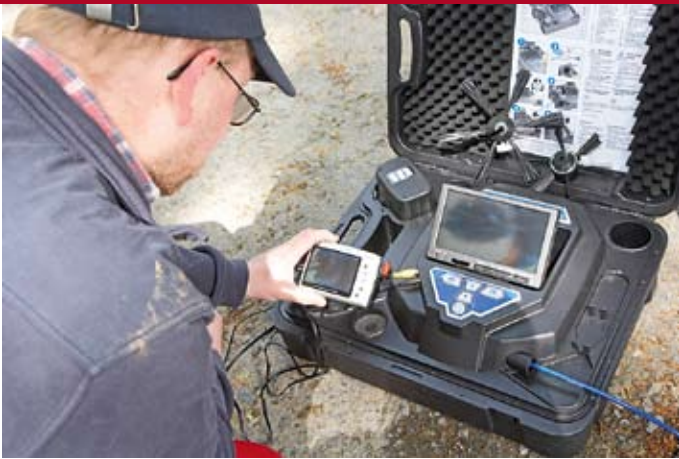
■ Die visuelle Inspektion nimmt einen hohen Stellenwert bei der Prüfung der Abwasserleitungen ein, weil hierbei erste Schäden feststellbar sind und Aufschlüsse zur Dichtheit des Systems gewonnen werden können.
