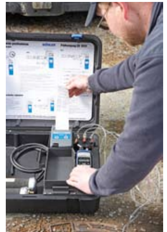
■ Der Ausdruck des Messergebnisses enthält neben sämtlichen Einstell- und Messwerten auch eine Grafik des Druckverlaufs während der Stabilisierungsphase und der Druckverlustprüfung.
