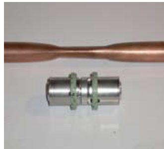
■ Die Deformation des abgebildeten Kupferrohres entspricht der Querschnittsverengung im gezeigten Verbundrohrfitting.
