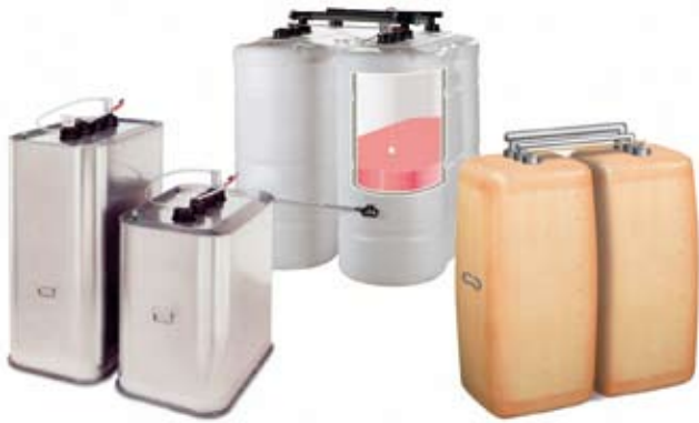
■ Bild 4: Doppelwandige Öltankanlagen sowie einwandige Öltanks aus GFK (entsprechend der Aufstellbedingungen in den Verordnungen der einzelnen Bundesländer) ersparen den Auffangraum und bieten ein Höchstmaß an Sicherheit. Bild: IWO
