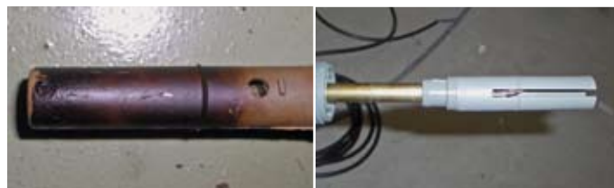
■ Bild 1: Heutige Grenzwertgeber (r.) sind konstruktionsbedingt gegenüber Grenzwertgebern alter Bauart (l.) verbessert und bieten eine höhere Funktionssicherheit. Daher sollten Grenzwertgeber alter Bauart durch den qualifizierten Fachbetrieb ausgetauscht werden.
