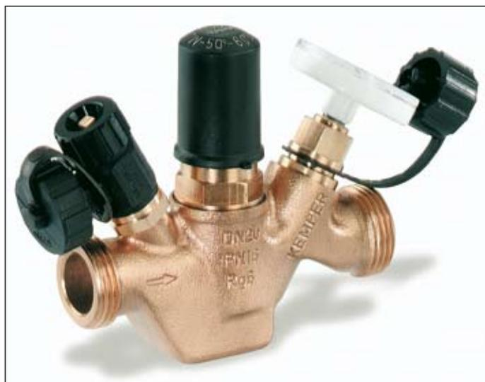
■ Die Einstellwerte für Zirkulations-Reguliertventile ergeben sich aus den Daten der nach DVGW-W 553 durchgeführten Rohrnetzrechnung. Allgemein kann die erforderliche Ventilgröße unter Umständen von der Rohrenweite abweichen. Das Reguliertventil Multi-Therm von Kemper besitzt die Zertifizierung nach DVGW VP 554 für die Einregulierung von Zirkulationssystemen. Bild: Kemper
