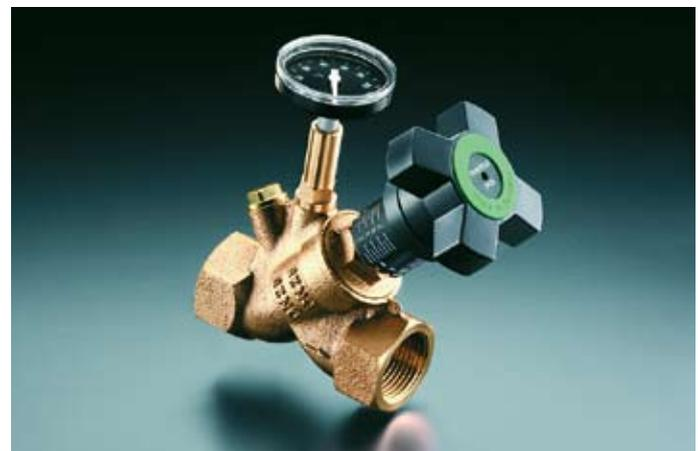
■ Das Strangreguliertventil Aquastrom C von Oventrop verfügt über eine reproduzierbare Voreinstellung und lässt sich auch für sehr geringe Volumenströme präzise einstellen. Als Thermostat-Variante bietet der Hersteller das Ventil Aquastrom T plus an, das auch die thermische Desinfektion unterstützt. Bild: Oventrop
