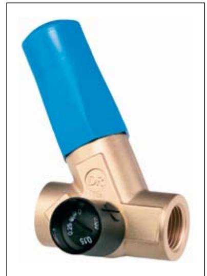
■ Der Zirkulationsregler ZR 40/65 von Vortex wird über ein Thermostatelement geregelt und ist in der Werkeinstellung auf 57 °C voreingestellt. Die Durchflussmenge beträgt maximal 0,3 m³/h, der zulässige Druckverlust 1 bar. Aufgrund eines integrierten Bypasses ist der Zirkulationsregler auch für die thermische Desinfektion geeignet. Bild: Deutsche Vortex
