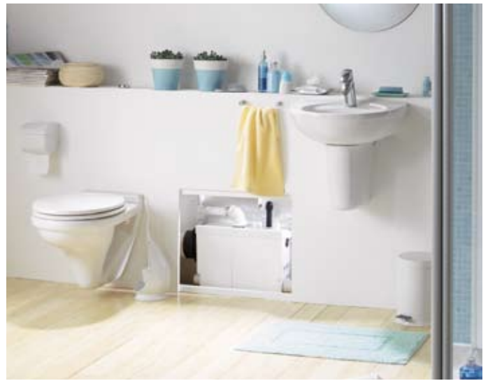
■ Kleinsthebeanlagen nach DIN EN 12050 Teil 3 sind zur begrenzten Verwendung für die Entwässerung von 1 WC, 1 Waschbecken und 1 Dusche in Sanitärräumen untergeordneter Nutzung zugelassen. Die Entwässerungsgegenstände müssen sich dabei im selben Raum befinden, dem Nutzerkreis muss oberhalb der Rückstauenebene ein WC zur Verfügung stehen. Bild : SFA Sanibroy
