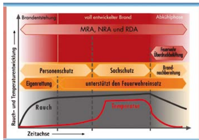
■ Bild 1: Zeitliche Abfolge der Rauch- und Temperaturentwicklung in Abhängigkeit von Schutzziel und Anlagentechnik.
