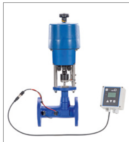
Der Haupteinsatzbereich für die Strangregulier- und Messventile „BOA-Control“ und „BOA-Control IMS“ von KSB ist der hydraulische Abgleich von Heiz- und Kühlkreisläufen. Durch das integrierte Absperrventil ist keine zusätzliche Absperrarmatur nötig. Zusammen mit einem Stellantrieb mit integriertem Prozessregler bildet die Ausführung „BOA-CVE Control IMS“ (Bild) einen autarken Regelkreis für die automatisierte Sollwert-Ausregelung der Regelstrecke.
