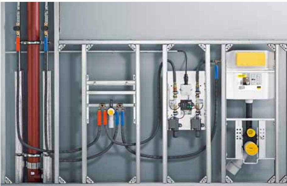
Die Viega-Spülstation mit Hygiene+ Funktion wird dezentral zur Absicherung stagnationsgefährdeter Bereiche installiert und vorwiegend in solchen Gebäuden eingesetzt, wo Nutzungsunterbrechungen zu erwarten sind. Die Spülstation simuliert wie ein elektronischer Nutzer den bestimmungsgemäßen Betrieb. Bild: Viega
