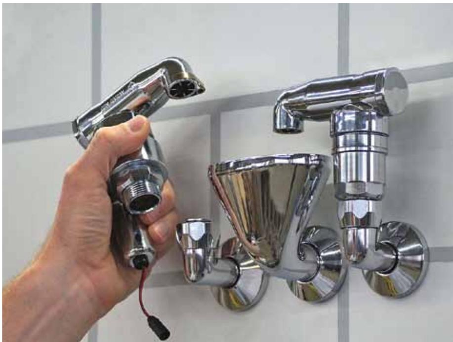
Zur Absicherung der nicht durchströmten Anbindeleitungen zu vorhandenen Rohrbelüftern (Bauform E, mit Ablauftrichter) kann der SEPP-Safe Spül-Nachrüstsatz eingesetzt werden. Durch diese Lösung wird kein Rückbau der vorhandenen Leitungen notwendig. Bild: Seppelfricke
