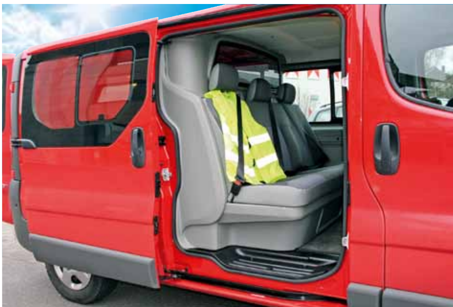
Integrierte Doppelkabine möglich: Eine Kombination aus Sitzbank und stabiler Kunststofftrennwand für Mannschaft und Fracht – hier im Renault „Trafic“.
