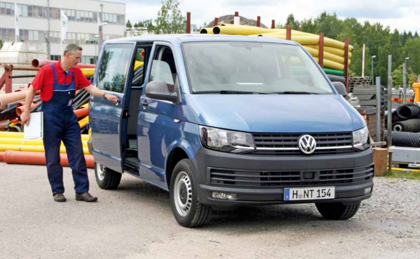
Typisch Kompakt-Transporter: Der VW „T6“ mit Normallänge und Flachdach bietet einen nutzbaren Laderaum von etwa 5,8 m 3 .
