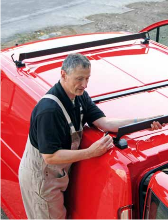
Aerodynamisch günstige Option fürs Flachdach: Drei Traversen lassen sich beim Ford „Custom“ als Dachträger hochklappen. Bild: Ute Schmidt
