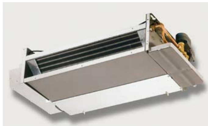
■ Typische Einbausituation in Hotelzimmern: Beim Zwischendeckeneinbau saugen die Geräte Raumluft von unten an, oder werden mit Primärluft einer RLT-Anlage versorgt. Die temperierte Luft wird über ein Gitter in den Raum eingebracht.
