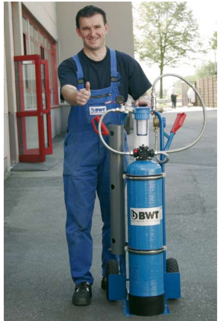
■ Wasserseitigen Ablagerungen kann vorgebeugt werden, wenn ausschließlich teilenthärtetes Füllwasser verwendet wird, z. B. durch eine mobile Enthärtungsanlage. Bild: BWT Wassertechnik
