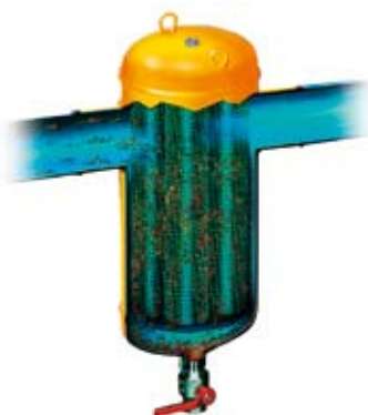
■ Schnitt durch den Schlammabscheider von Spirovent. Beim Öffnen des Ablasshahns wird der gesammelte Schlamm herausgepresst, sodass der Hahn in Sekundenschnelle wieder zugedreht werden kann.
