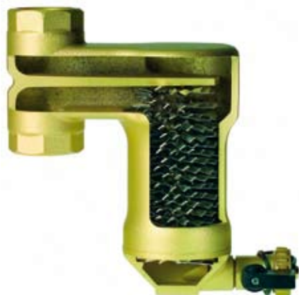
■ Schnitt durch den Mikroblasen- und Schlammabscheider von Pneumatex. Der Heizungswasser-Durchfluss bleibt laut Hersteller immer konstant. Das Prinzip beruht auf der sogenannten helicoidalen Schlammabscheidung.
