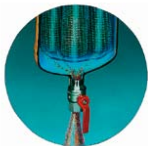
■ Schnitt durch den Schlammabscheider von Spirovent. Beim Öffnen des Ablasshahns wird der gesammelte Schlamm herausgepresst, sodass der Hahn in Sekundenschnelle wieder zugedreht werden kann.
