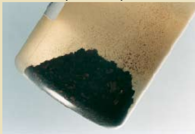
■ Wasserprobe aus einer reklamierten Anlage.
