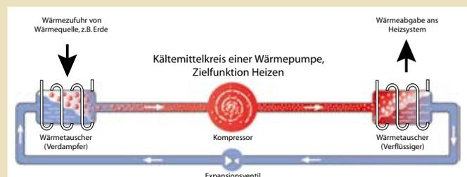
■ Kältemittelkreis einer Wärmepumpe mit Verdampfer, Kompressor, Verflüssiger und Expansionsventil.
