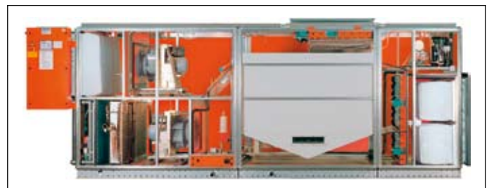
■ Bild 6: Klimagerät „Adsolair“ Typ 58 mit integrierter Verdunstungskühlung und zusätzlicher Kompressionskältemaschine. Hierbei ist es möglich, die anstehende latente Wärme der Außenluft zu entziehen und über einen geräteinternen Kältemittelrückkühler mit der Fortluft abzuführen. Dabei kann die Planung von gesonderten Rückkühlwerken und Kältemittelleitungen außerhalb des Gerätes entfallen.
