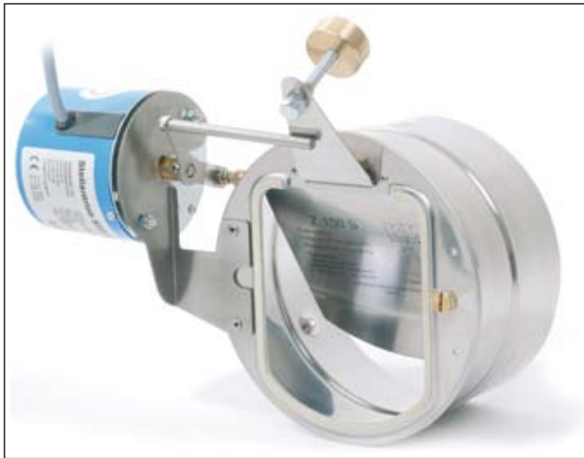
Bild 2: Bei einer kombinierten Nebenluftvorrichtung wird in der Stillstandszeit die Regelscheibe des Zugbegrenzers mittels Stellantrieb geöffnet.
