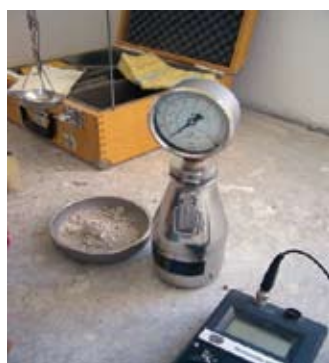
■ Bild 7: CM-Messgerät zur Messung der Estrichfeuchte.
