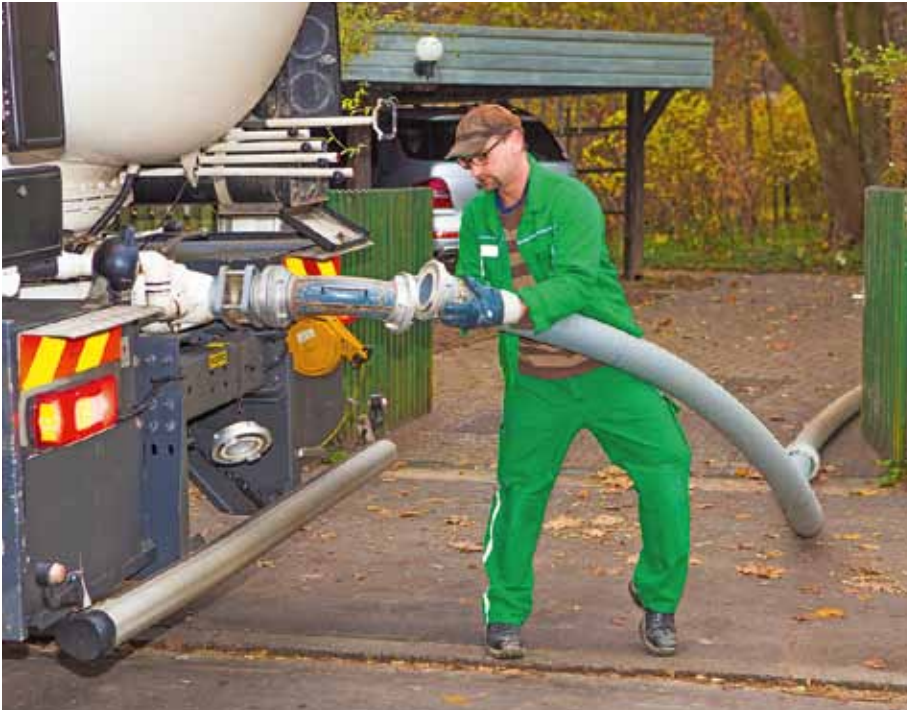
Der Fahrer ist besonders geschult und stellt sicher, dass die Pellets sachgerecht und schonend in das Lager des Kunden eingblasen werden.
