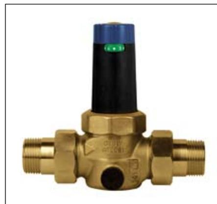
Der Druckminderer „315 AB“ gilt bei SYR als das ideale Austauschmodell: Er hat die gleichen Baumaße wie herkömmliche Druckminderer und ist in den Anschlussgrößen DN 15 bis DN 50 erhältlich. Zum Ausbau des Ein-Kartuschen-Systems muss lediglich die Überwurfmutter an der Druckminderer-Patrone gelöst werden. Weiterer Vorteil: Aufgrund der speziellen Kartuschenkonstruktion muss der Druck nach dem Reinigungsvorgang nicht wieder neu eingestellt werden.
