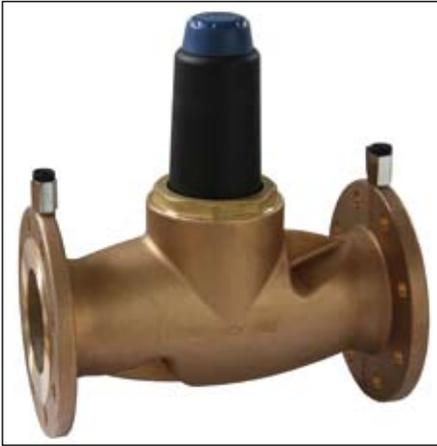
Dieser Flanschdruckminderer schützt industrielle und gewerbliche Anlagen vor zu hohem Versorgungsdruck. In den Größen DN 65 bis DN 100 regelt die Armatur den Druck von 16 bar Eingangsdruck auf 1,5 bis 6 bar Ausgangsdruck. Die Druckminderer-Kartusche kann zur Wartung einfach ausgebaut und ersetzt werden, ohne dass die Armatur ausgebaut werden muss.
