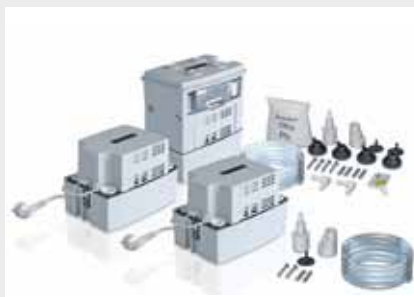
Grundfos offeriert die Kondensat-Hebeanlagen der Baureihe Conlift in einer neuen Technikgeneration und in drei Varianten. Vier Zuläufe in jeder Richtung und ein um 180° drehbarer Motor vereinfachen die Installation. Der Pumpenmotor verkraftet Schalthäufigkeiten bis zu 60 Starts pro Stunde. Mit einem manuellen Handtaster kann die Funktionsbereitschaft der Hebeanlage überprüft werden. Bild: Grundfos
