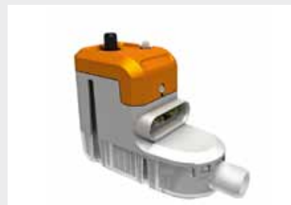
Die Schwingkolbenpumpe SI-10 von Sauerermann wurde für den Universaleinsatz in Klimageräten bis 20 kW Kühlleistung (Förderleistung max. 20 l/h) entwickelt. Das Geräuschniveau wurde nach EN ISO 3744 (auf 1 m, Pumpe in Betrieb mit Wasser, frei hängend) mit 22 dBA ermittelt. Bild: Sauerermann
