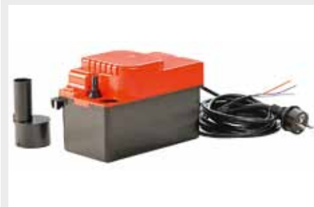
Der Kondensat-Lift ergänzt das Hebeanlagen-Sortiment von KSB für die sichere Ableitung von Kondensat aus Klima- und Kühlanlagen. Die vollautomatische Hebeanlage fördert bis zu 340 l/h Flüssigkeit auf eine Höhe von bis zu 4,50 m. Bild: KSB
