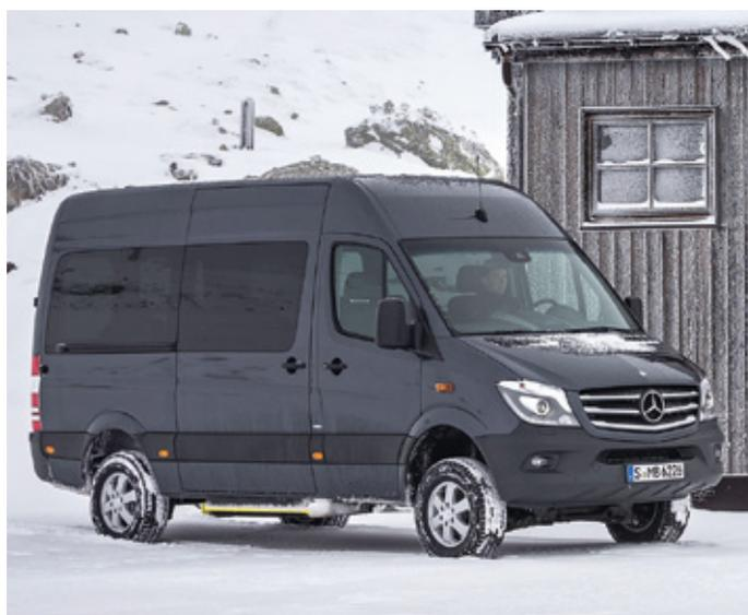
Ziemlich sicher, dass der ankommt: Mit höher gelegter Karosserie sowie zuschaltbarer Allradtechnik plus elektronischen Regelassistenten ist der „Sprinter“ 4x4 ausgestattet. Bild: Mercedes-Benz
