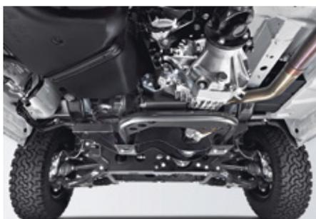
Top-Technik zu sehen: Neben dem 6-Gang-Schaltgetriebe ist für den permanenten Allradantrieb des VW „Crafter“ ein eigenständiges 3-Wellen-Verteilergetriebe verbaut. Bild: Achleitner
