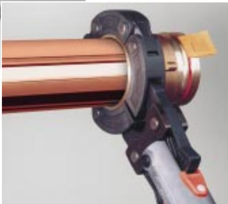
**Bild 9:** Preßbacke auf das Preßwerkzeug stecken und Haltebolzen bis zum Einrasten schieben.
