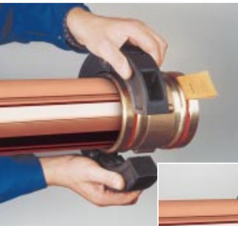
**Bild 8:** Beim Aufsetzen der Preßkette auf den Preßverbinder ist der richtige Sitz gewährleistet, wenn Preßkette und Verbinder bündig sind.
