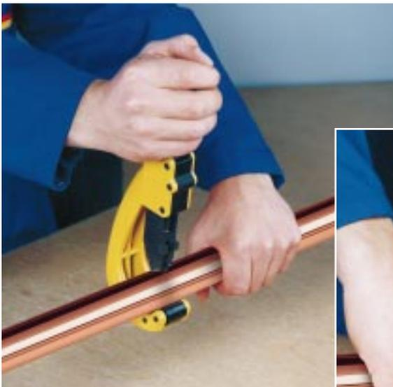
**Bild 1:** Kupferrohr rechtwinklig mit Rohrschneider oder feinzahniger Stahlsäge ablängen.
