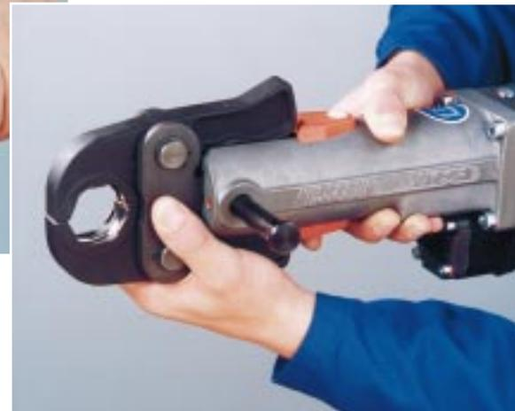
**Bild 6:** Das elektrohydraulische Preßwerkzeug: Preßbacke mit der passenden Abmessung aufstecken und Haltebolzen bis zum Einrasten einschieben.
