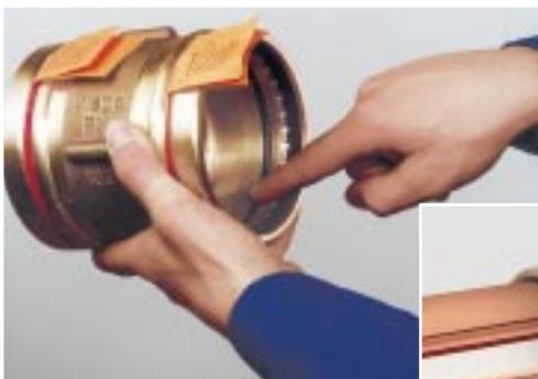
**Bild 5:** Korrekten Sitz des Dichtelementes und des Schneidrings überprüfen. Keine Öle und Fette verwenden.
