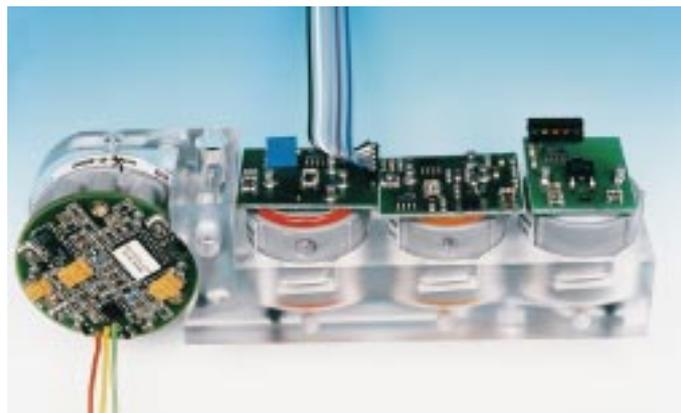
**Bild 3:** Gasanalyse-einheit mit elektrochemischen Meßzellen für CO, NO und O<sub>2</sub>.
