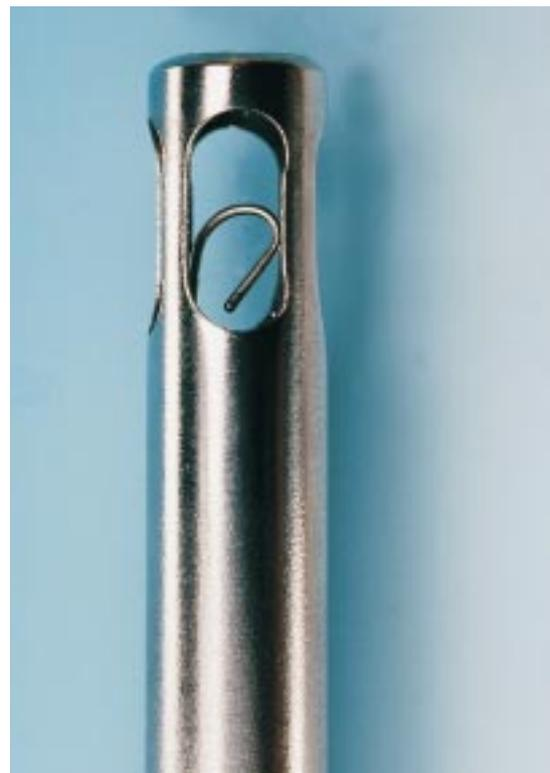
**Bild 2: Sondenspitze mit innenliegendem Mantelthermoelement.**
