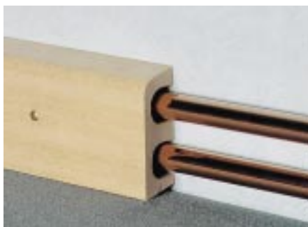
Bild 2: Sockelleiste aus Abachi-Massivholz für Rohre bis 18 mm Außendurchmesser (Einrohrleiste für Rohre bis 28 mm).
