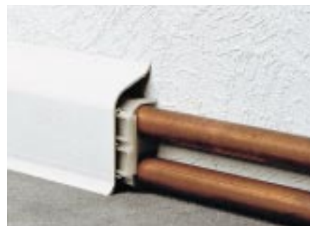
Bild 4: Sockelleiste mit weichen Dichtlippen zur Wand und zum Fußboden, für Rohre bis 22 mm Außendurchmesser, gehalten von vorn aufsteckbaren Schellen.
