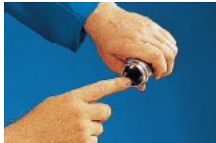
Bild 3: Korrekten Sitz des Dichtelementes prüfen. Kein Öl und Fett verwenden!
