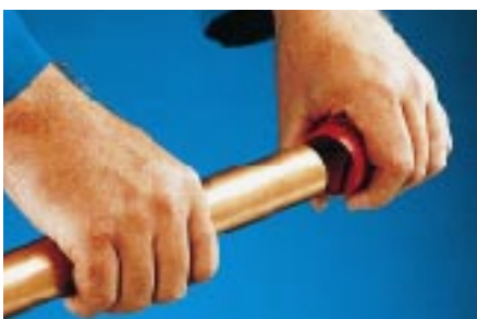
Bild 2: Innen und außen entgraten.
