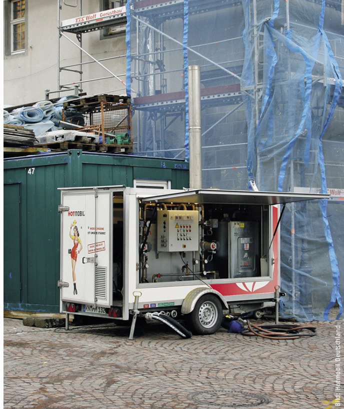
Der „Klassiker“ in der Hotmobil-Mietflotte ist die 150 kW starke Heizzentrale im Anhänger. Sie dient von der Baubeheizung bis hin zur Übergangsversorgung beim Ausfall einer Heizungsanlage.
