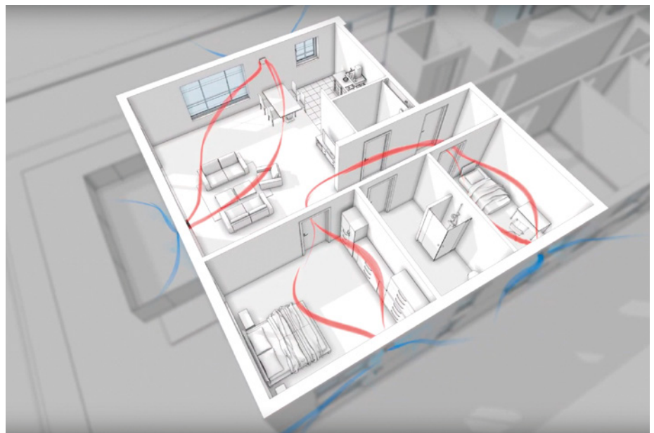
Für Einzelräume, Wohnungen oder das ganze Haus: Ein dezentrales Lüftungssystem besteht aus mindestens zwei Lüftungsgeräten und eignet sich auch bestens für die Sanierung, da die Verlegung eines Luftverteilsystems entfällt.
