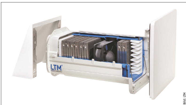
„Thermo-Lüfter 200-50“: Trocknungspotenziale in Kellerräumen werden über die h,x-Regelung erkannt und angestrebte Idealzustände nutzerunabhängig eingeregelt.
