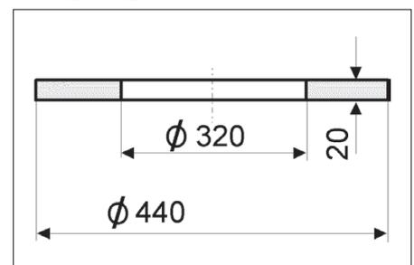
Berechnen Sie die Masse des skizzierten Flanschringses aus Stahl bei einer Dichte  $\rho$  von  $7,85 \text{ g/cm}^3$ .
