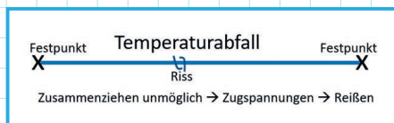
Bild 3: Zugspannungen bei Temperaturabfall.
