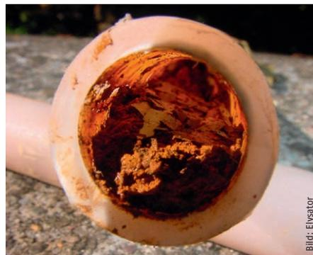
Ein Korrosionsprozess benötigt immer Sauerstoff und ein Elektrolyt, also ein elektrisch leitendes Medium = Heizungswasser. Welche Aussagen stimmen in diesem Zusammenhang?
