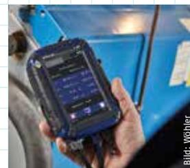
Ein typisches Abgasmessgerät, das „A-450“ von Wöhler. Auf dem Farbdisplay werden alle Messwerte auf einen Blick dargestellt.
