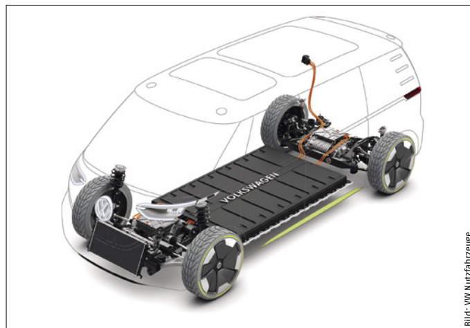
E-Antrieb der Zukunft: Wie hier beim „I.D.Buzz“ (VW Nfz) bilden Vorder- und Hinterachse jeweils mit dem E-Antrieb eine Einheit. Wie Schokoriegel füllen flache Batterien den Sandwichboden. Durch die Anzahl lässt sich entweder mehr Nutzlast oder mehr Reichweite für den Elektro-Bulli erzielen.
