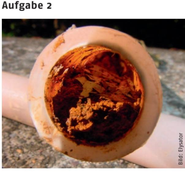
Ein Korrosionsprozess benötigt immer Sauerstoff und ein Elektrolyt, also ein elektrisch leitendes Medium = Heizungswasser. Welche Aussagen stimmen in diesem Zusammenhang?
