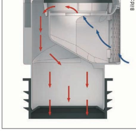
Für die Installation von Schmutzwasserleitungen ergibt sich durch Belüftungsventile eine größere Flexibilität. Was ist mit dieser Flexibilität gemeint?
