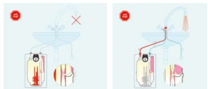
Bild 6: „Antitropf“-Funktion: Beim Aufheizen dringt das Wasser in ein Reservoir ein und drückt eine Membrane zusammen. Der nächste Zapfvorgang entleert das Reservoir wieder.
