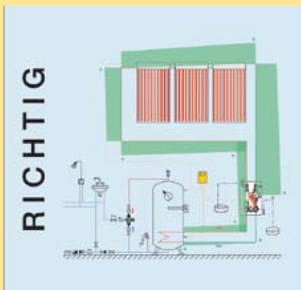
Anschluss Ausdehnungsgefäß vor der Pumpe.
