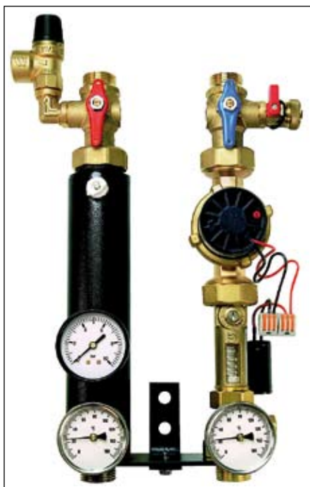
Pump-, Regulier- und Entlüftungseinheit: Die anschlussfertige Solarstation „Tacosol EU21“ ist auch in einer Ausführung mit Solarstrom-Pumpenantrieb erhältlich. Die Pumpendrehzahl wird dabei abhängig von der Sonneneinstrahlung selbsttätig geregelt.
