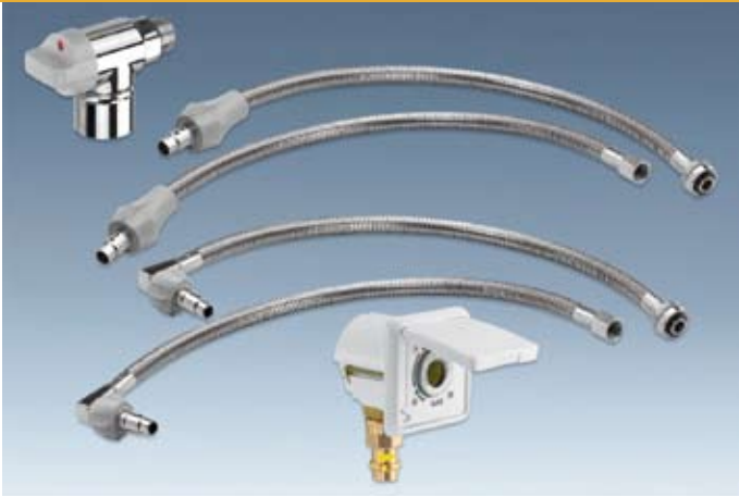
■ Bild 6: Die zahlreichen Schlauchvarianten und Geräteanschlüsse, hier z. B. von Systemanbieter Viega, müssen nach DIN 3383-4 und DVGW VP 635-2 geprüft und zugelassen sein.
