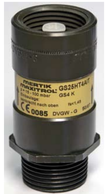
■ Bild 4: Bei der Installation von Kunststoff-Innenleitungen fordert die DVGW-TRGI 2008 grundsätzlich den Einbau eines leistungsangepassten Gasströmungswächters, der unmittelbar wärmeleitend mit einer zusätzlichen thermisch auslösenden Absperrvorrichtung verbunden sein muss.
