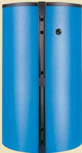
Die Pufferspeicher „Logalux PR“ von Buderus haben 500, 750 oder 1000 l Inhalt und speichern über eine temperatursensible Rücklaufeinspeisung die Wärme zwischen.
