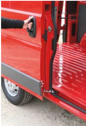
■ Nur durch Entriegeln am Griff lässt sich die geöffnete Frachtraumtür lösen.
