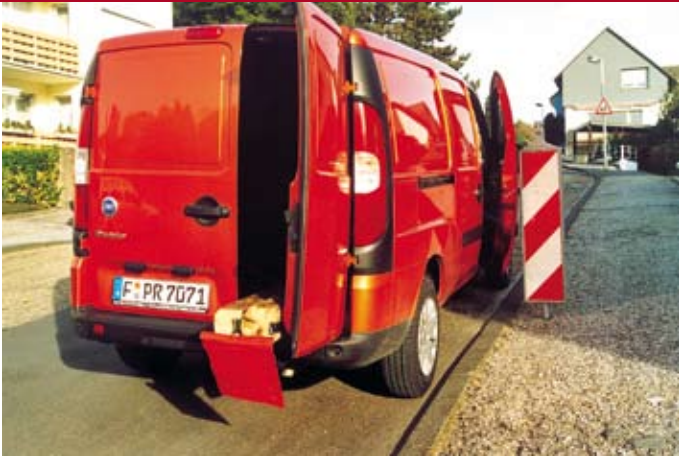
■ Praxispflicht: Für extra lange Ladung kann der schmalere, rechte Flügel offen bleiben. Protektoren verhindern das Anstoßen der vorderen Türen.
