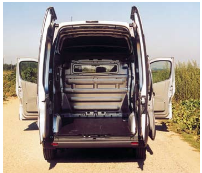
■ Bei der Hochdach-Variante erreicht der Laderaum des Vivaro max. 8,3 m 3 , und die Hecktüren eröffnen eine Ladehöhe von 181 cm.
