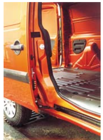
■ Verschlechtert: Im Gegensatz zum Kombi rastet die schmale Schiebetür in Endstellung nicht ein. Die Seitenwände sind überwiegend ungeschützt.
