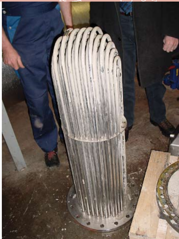
■ Bild 5: Nur etwa 1700 g Kalk hatte der Wärmetauscher in dem Testzeitraum angesetzt. Der Vergleich zur Ausgangssituation entspricht einer Reduktion der Kalkablagerungen um 98 %.
