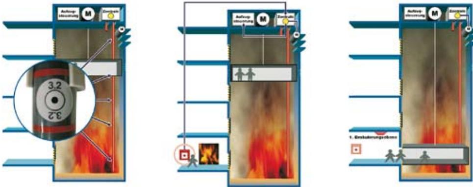
■ Das Rauchabzugssystem „Lift-Smoke-Free“ saugt über ein Rohr kontinuierlich Luft über einen Sensor. Im Falle einer Brandgas-Detektion im Fahrstuhl oder durch manuelle Alarmierung wird die Jalousieklappe geöffnet. Die Aufzugssteuerung fährt dann die erste Evakuierungsebene an.
