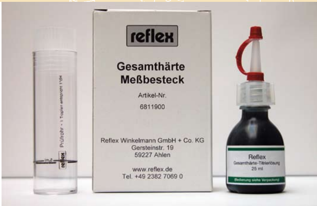
■ Bild 3: Mit einem Gesamthärte-Messbesteck kann die Härte des Nachspeisewassers bestimmt werden. Anhand der Gesamtleistung und des Anlagenvolumens wird entschieden, ob Maßnahmen zur Vermeidung von Kesselstein getroffen werden müssen.
