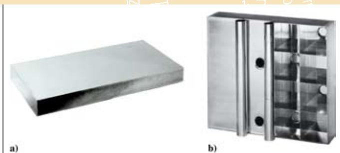
■ Bild 5: Modell eines beidseitig absorbierenden Membran-Absorbers a) mit teilweise abgewickelten Loch- und Deckmembranen b) aus Aluminium [3].
