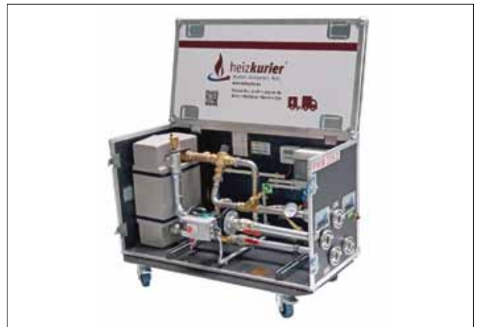
Dieses Frischwassermodul liefert zwischen 1000 und 18500l Trinkwasser von 30 bis 60°C pro Stunde. Da die Trinkwassererwärmung über eine Frischwasserstation erfolgt, entfällt der Speicher. Bild: Heizkurier
