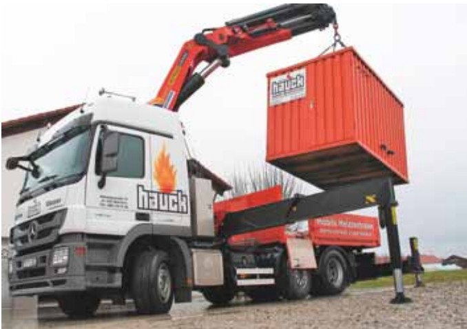
Mobile Heizzentralen großer Leistung erfordern entsprechend viel Platz für alle Komponenten, wie Heizkessel, Ausdehnungsgefäß und Sicherheitseinrichtungen. Die in einem Container fix und fertig installierte Anlage kann nur per Lkw zum Einsatzort transportiert werden. Bild: Hauck
