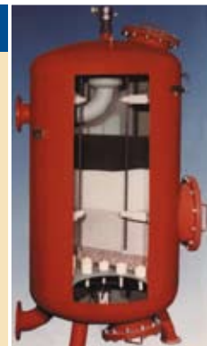
■ Die im Reaktionsbehälter eingebaute Anode wird abhängig vom Durchfluss mit maximal 40 V Gleichspannung beaufschlagt.
