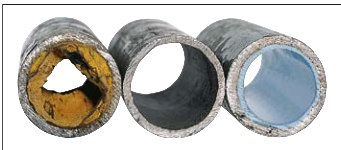
■ Beispiel einer Rohrrinnenbeschichtung.
