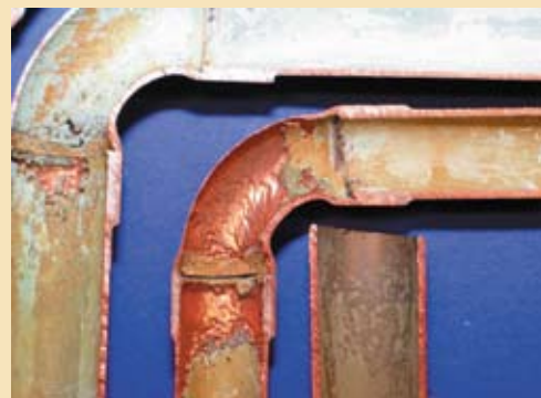
■ Erosionskorrosion an einem Kupferfitting.
