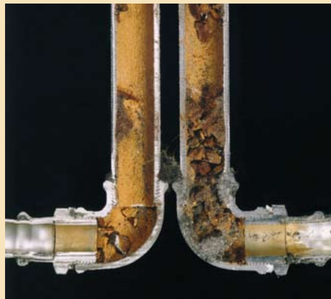
■ Querschnittsverminderung durch Ablagerungen.
