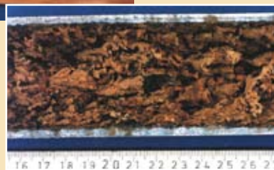
■ Erosionskorrosion an einem Kupferfitting.
